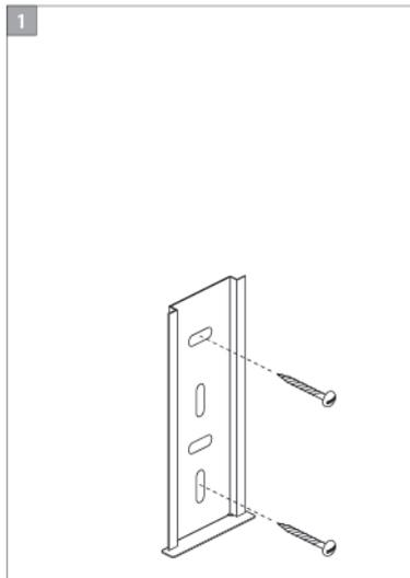
Die untere Montagehalterung wird mittels zwei Schrauben\* an der Wand befestigt.
