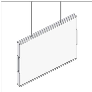
Die Deckenbefestigung erfolgt wahlweise mittels herkömmlichen Haken oder der Deckenautomatik. Die Automatik läßt ein nachträgliches Justieren zu, so dass Unebenheiten, sowie kleine Unterschiede in der Seillänge mühelos ausgeglichen werden können.
