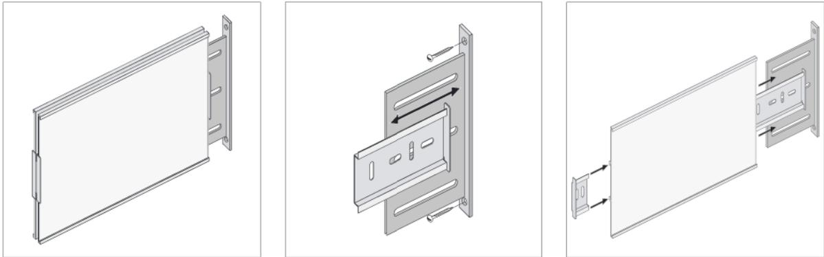
Die Montage erfolgt mittels zwei Schrauben\*, welche durch die Bohrungen in die Wand verschraubt werden.
