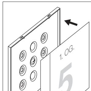
Beim Einbringen der Papiereinlage ist darauf zu achten, dass diese unter die Einstelllaschen geschoben wird.
