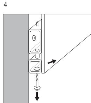
4 Falls erforderlich Sicherungsschraube herausdrehen. Tafel abhängen.
