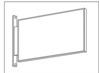
Die Montage erfolgt mittels zwei Schrauben, welche durch die seitlichen Bohrungen in die Wand verschraubt werden.
