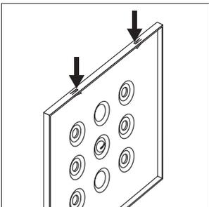
Um eine sichere Fixierung der Scheibe zu gewährleisten, die beiden Einstelllaschen an der Oberseite der Trägerplatte leicht eindrücken.
