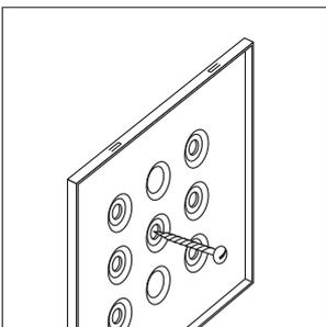
Nach dem Setzen der Dübel das Türschild mit zwei Schrauben (bei geeigneter Wandbeschaffenheit genügt unter Umständen auch nur eine Schraube) anbringen.
