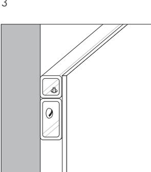
3 Tafel oben einhängen. Tafel an der unteren Blockiersicherung an der Wand festdrücken.
