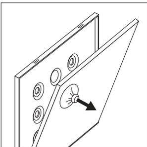
Mit Hilfe des Saugknopfes die Acrylglascheibe (PMMA) abziehen. Anschließend die Trägerplatte mit den beiden Selbstklebefolien auf der Rückseite an der Wand fixieren.
