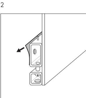
2 Schutzfolie von der Blockiersicherung (unten) abziehen.
