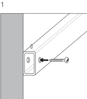
1 Nach dem Setzen der Dübel das Vierkantrohr oben anschrauben.
